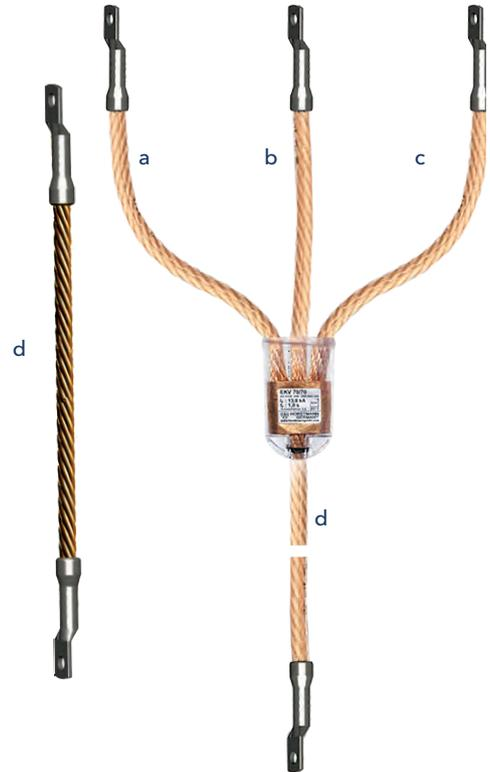
Längen von Erdungs- und KurzschlieÙseilen an AnlagenmaÙe und Abstände zwischen AnschlieÙteilen (mind. 1,2-facher Abstand) anpassen. Zu lange Seillängen (>1,5-facher Abstand) schlagen im Kurzschlussfall stark aus und müssen mit verlässlichen Hilfsmitteln, z. B. einem isolierenden Seil, an einem Holzmast verankert werden.
